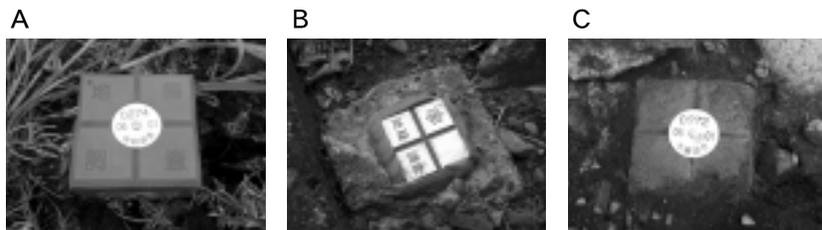
⑤地籍調査の結果埋設された杭の一例。左から、A：新たに埋設されたプラスチック杭、B：境界点上のコンクリートに接着した境界票、C：既存のコンクリート杭が使用可能だったので地籍調査の番号票のみを敷設したもの。これらの杭は、紛失などしても新たに役場の費用では埋設できないので、大切に管理していきましょう。
