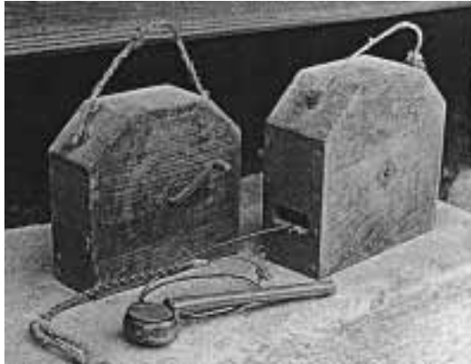
明治時代に行われた土木工事では、写真のような巻尺などを使い、測量が行われました (写真：巻尺と矢立て)
